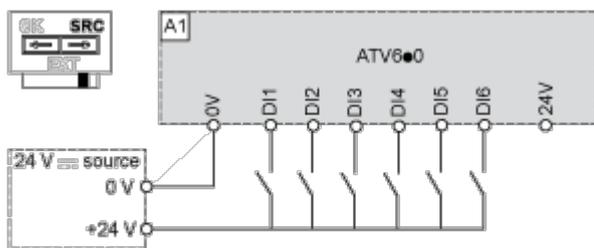
切换设置为 **SK** (漏型) 位置，将使用输出电源给逻辑输入供电
