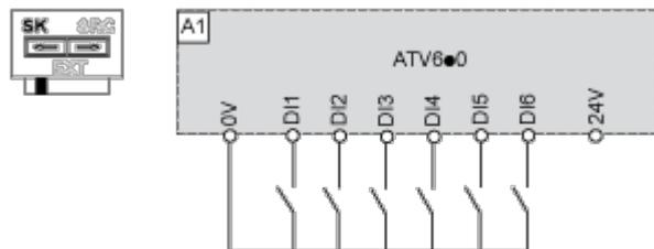
切换设置为 **EXT** (外部) 位置，将使用外部电源给逻辑输入供电
