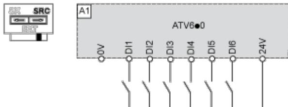
切换设置为 **SRC** (源型) 位置，将使用外部电源给逻辑输入供电
